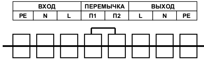
Рис 4. Схема подключения СБП на мощность 6 кВА.
