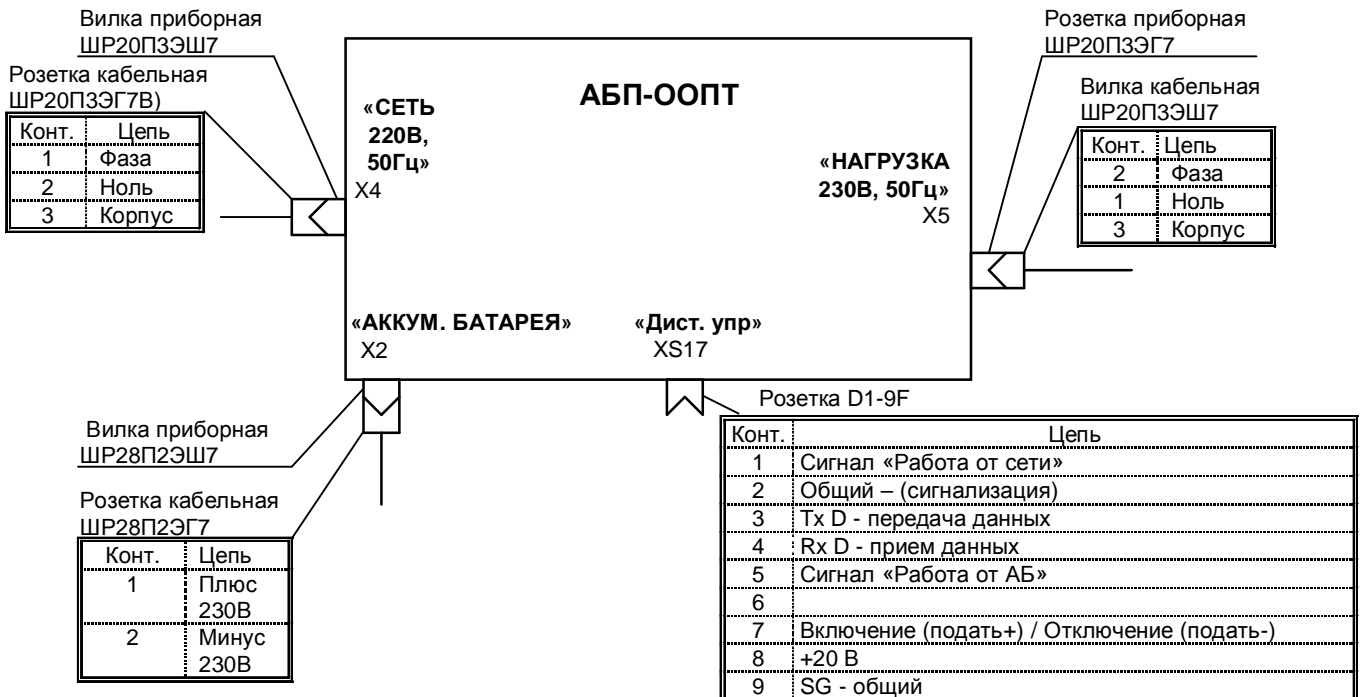
Рис. 2. Схема подключения агрегатов бесперебойного питания АБП на токи свыше 8А.
